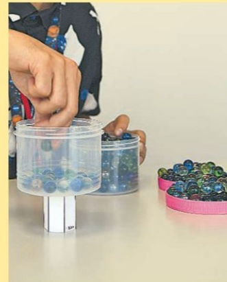
六角形の筒の上の容器にどんどんビー玉を載せてみよう
