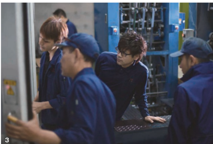
1. 印刷局はシフト制で緊張感ある職場ですが、雰囲気は明るい。一息つけるときには、先輩方とよく冗談を言って笑っています 2. 印版を超高速度タワー型輪転機に装着。四つのオフセット輪転機を重ねた構造で高さは20mあり、6階建てのビルに相当します。4色(シアン・マゼンタ・イエロー・ブラック)の印版をそれぞれの輪転機にセットします 3. 折機から毎時15万部のスピードで折りたたまれた新聞が出てきます 4. 折機から出た刷りたての新聞は、すぐに全員で開いて確認。ページ建てに誤りがないか、色はちゃんと再現できているかなどをチェックします
